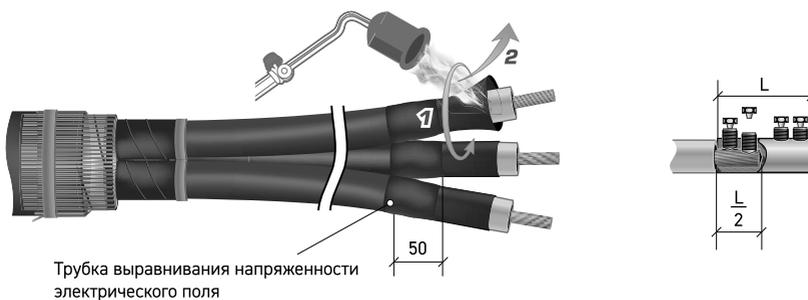
Трубка выравнивания напряженности электрического поля
